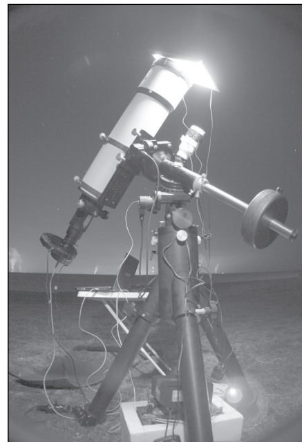
Autorova fotografická sestava (jedna z mnoha), využívající kameru Atik 314L+ ve spojení s refraktorem 152/900
