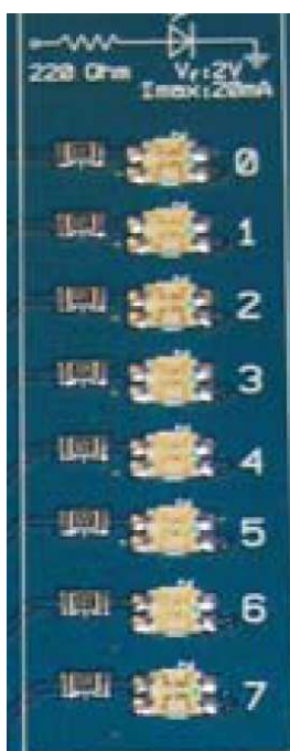
Rys. 2. Diody świecące LED wraz z rezystorami ograniczającymi prąd.
