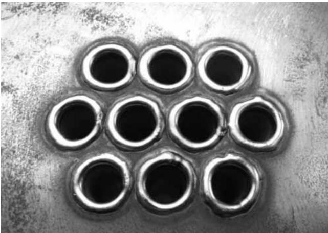
Rys. 9. Złącze próbne z układem trójkątnym rur, wykonane zgodnie z wytycznymi podanymi w tabeli IV
